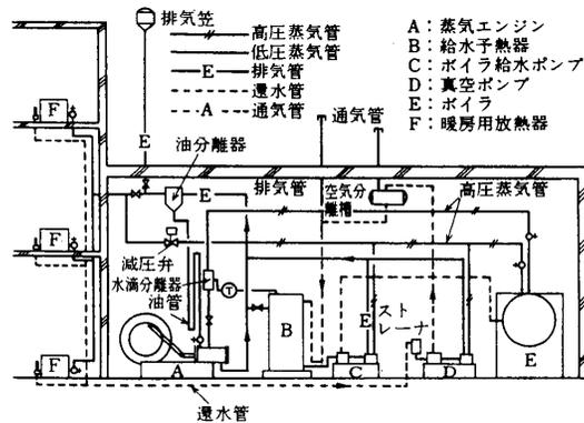
図 4.18 ウェブスター式蒸気暖房
