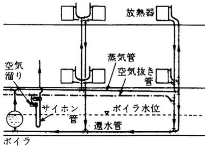
図 4.17 ケルチング式蒸気暖房
