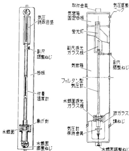
図 フォルトン型水銀気圧計（出典：参考文献 [2]，p. 82）
